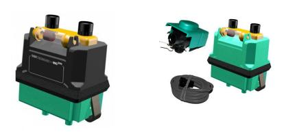
P500A — электронный пульсатор, состоящий из оригинального корпуса, двух соленойдных клапанов и уплотнений. Пульсатор получает команды с ED200 и создает пульсацию вакуума в доильном аппарате. Он полностью управляется модулем ED200.
