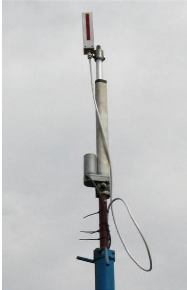
Рисунок 15 - Установка актуатора АК-1, сверху-вниз: приемник, актуатор с выдвижным штоком, подвижная штанга в мачте с механическим Г-образным зажимом.
