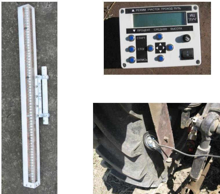
Рисунок 4 - Автонивелир АН-3: слева - приемник с держателем, справа сверху - пульт управления, справа внизу - датчик пути, прижимаемый металлической пластиной к колесу трактора.
