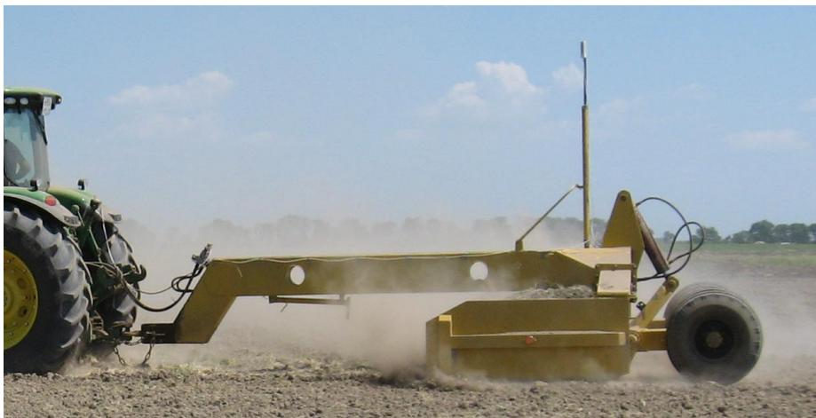
Рисунок 10 – Короткобазовый планировщик ПАУ-4,2 с лазерным управлением.
