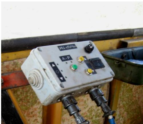
Рисунок 14 - Лазерно-приемное устройство ОКО-30: слева - приемник, справа- пульт управления в кабине трактора.
