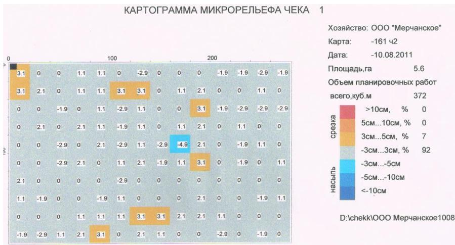
Рисунок 17 – Контрольная картограмма спланированного чека.
