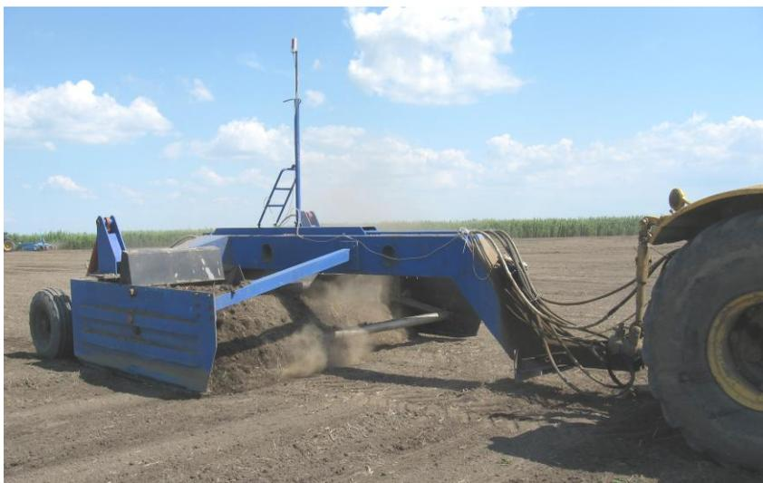
Рисунок 12 – Короткобазовый скрепер-планировщик СП-4,2 с лазерным управлением.
