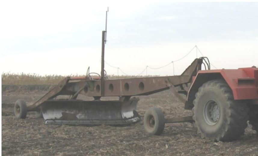
Рисунок 11 - Прицепной клин-планировщик КП-719 с лазерным управлением.
