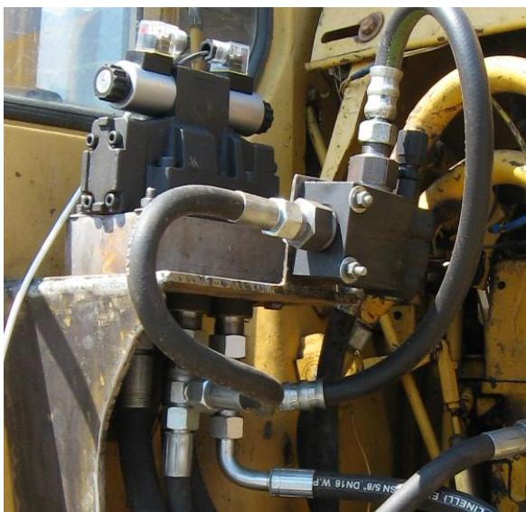
Рисунок 16 - Установка гидроблока ГБ-УК: слева - гидрораспределитель с золотником и электромагнитами, справа - гидроклапан.
