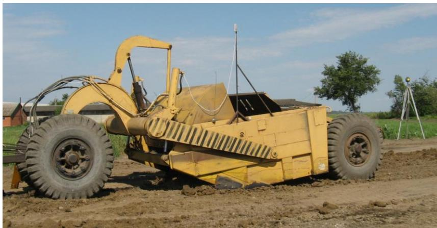
Рисунок 9 – Прицепной скрепер ДЗ-77 с лазерным управлением.
