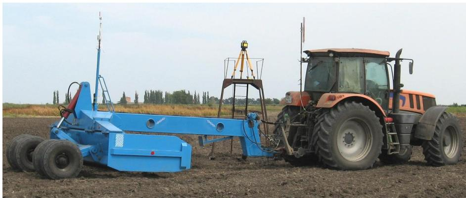
Рисунок 18 – Слева направо: планировщик ПАУ-4,2Р с приемником устройства ОКО-30, актуатором АК-1 и гидроблоком ГБ-УК; лазерный передатчик Rugby-810 на металлическом посту; приемник автонивелира АН-3 на тракторе Terrion Atm 5280.
