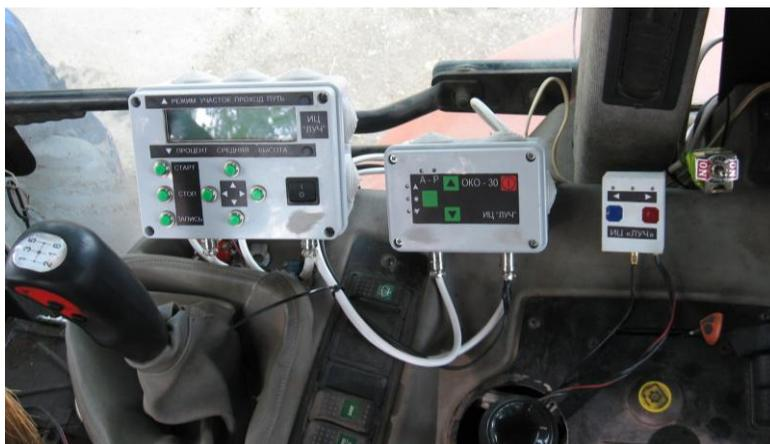
Рисунок 19 – Размещение в кабине трактора пультов управления, слева направо: автонивелира АН-3, устройства ОКО-30, курсового навигатора КН-1 и актуатора АК-1.
