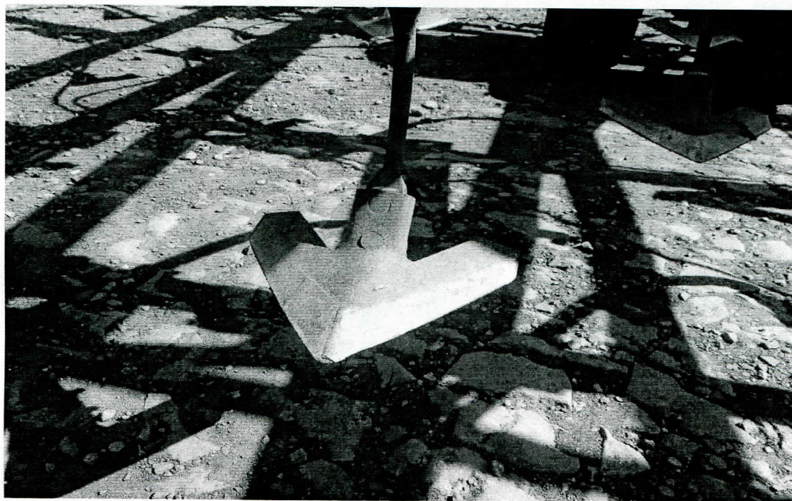
лапа Сэлфорд 290мм 8мм ширина, наработка 3500га
