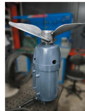
Применяются для перемешивания и усреднения густых агрессивных жидкостей с высокой концентрацией сухих веществ в различных резервуарах на сельскохозяйственных, животноводческих, пищевых и промышленных предприятиях, городских и бытовых очистных сооружениях.
