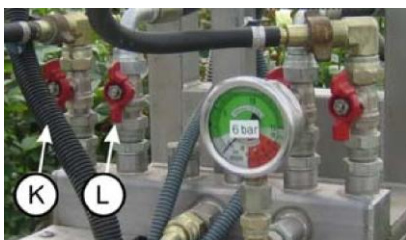
Фиг. 3.19 Краны подачи рабочей жидкости
