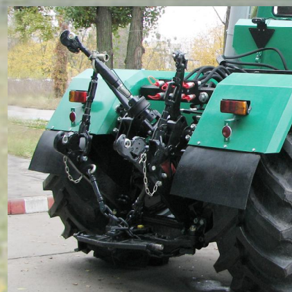
Заднее навесное устройство грузоподъемностью 5т
