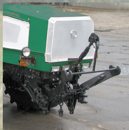
Переднее навесное устройство грузоподъемностью 4т
