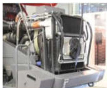
Радиатор охлаждающей жидкости с увеличенной водяной секцией и интеркулерам
