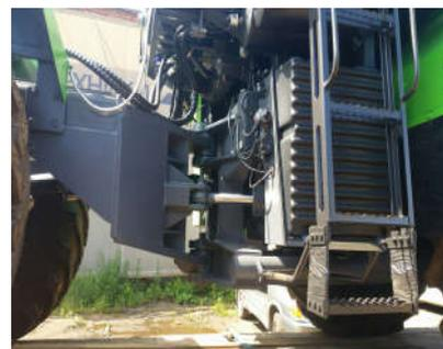
Рамная конструкция трактора без использования трубы шарнира с установкой балансира на подмоторной раме и рассчитанная на более значительные нагрузки
