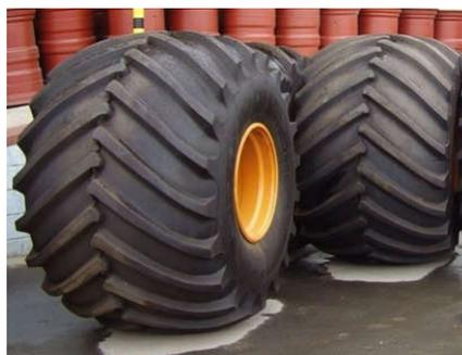
Наши трактора могут комплектоваться широкопрофильными шинами, тем самым снижая удельное давление на землю при работе в поле
