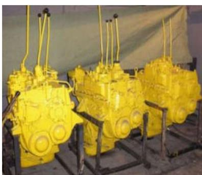
Новая модернизированная КПП с дополнительной (пятой) опорой
