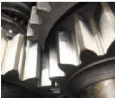
Усиленная трансмиссия: шестерни КПП и ведущих мостов изготовлены с повышенным классом точности
