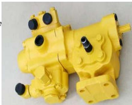
Гидравлический усилитель обеспечивает плавность хода рулевого колеса и значительно упрощает управление трактором
