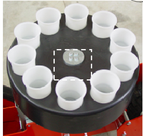
рис.D3.4 -вращающееся распределительное устройство
