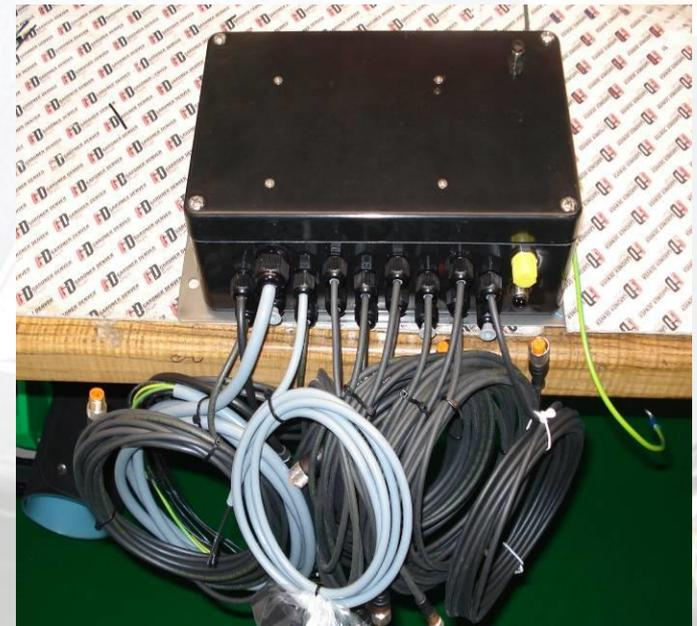
Легкая распределительная коробка и контроллер ввода/вывода помещены в легко монтируемый корпус. Поставляется с полностью подключенной GD разводкой. Производителям автоцистерн остается только размотать кабель (каждый из которых помечен биркой и цветовой маркировкой) и подсоединить к соответствующей клемме. Таким образом вопрос подключения и установки контролируется GD во избежание возникновения проблем влияющих на эффективность работы автоцистерны.
