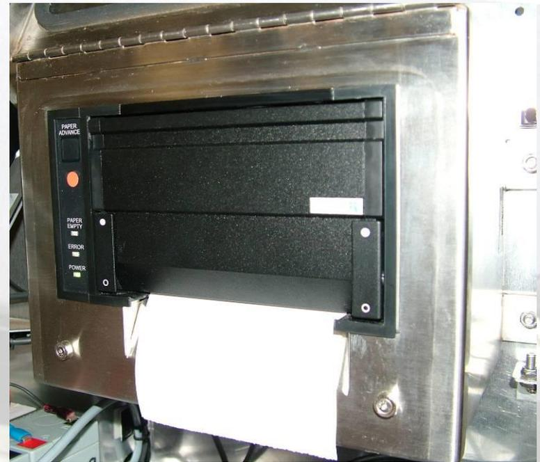
Системный принтер защищен корпусом из нержавеющей стали. Данный тип принтеров с технологией термопечати на рулонной бумаге используется в различных сферах и решениях применяемых Gardner Denver и доказал свою надежность. Замена бумаги производится очень легко.
